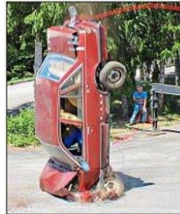
Der senkrechte Aufprall des Pkw aus zehn Metern Höhe soll die Verformung der Karosserie nach einem Aufprall eines mit 50 km/h fahrenden Fahrzeugs auf ein stehendes Hindernis simulieren.
