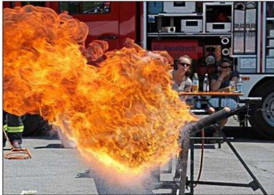
Eine kleine Menge Wasser genügt , um brennendes Fett zu einer riesigen Stichflamme werden zu lassen. – Fotos: Schauer
