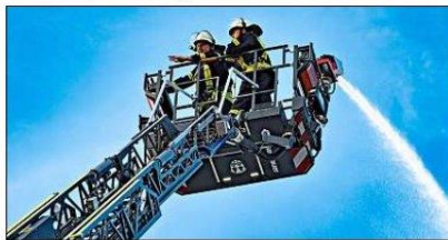
Der Löschmonitor wirft 2400 Liter Wasser in der Minute auf das Brandobjekt. – Fotos: Franz X. Eder
