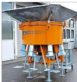
Etwa 3000 Sandsäcke kann die neue Anlage pro Stunde füllen.
