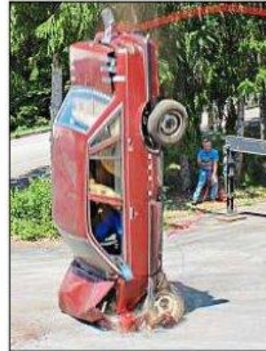
Der senkrechte Aufprall des Pkw aus zehn Metern Höhe soll die Verformung der Karosserie nach einem Aufprall eines mit 50 km/h fahrendes Fahrzeugs auf ein stehendes Hindernis simulieren.
