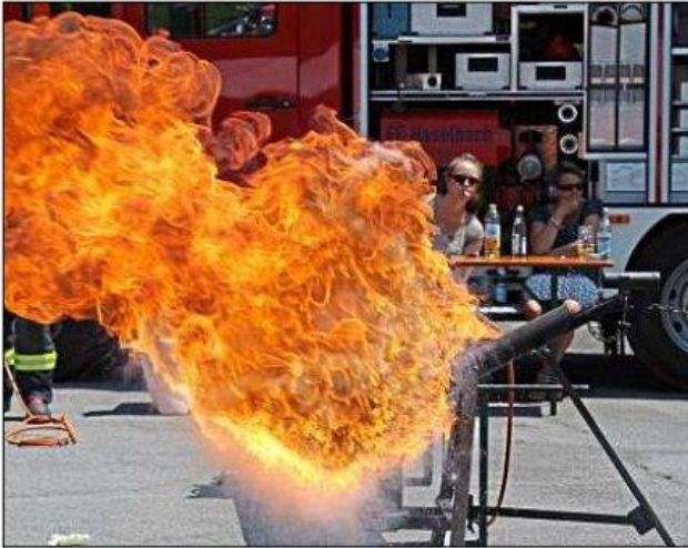
Eine kleine Menge Wasser genügt, um brennendes Fett zu einer riesigen Stichflamme werden zu lassen. – Fotos: Schauer
