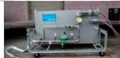
Diverse Anschlüsse um vorhandene Öffnungen am Silo für das Einbringen von Stickstoff vorzubereiten
